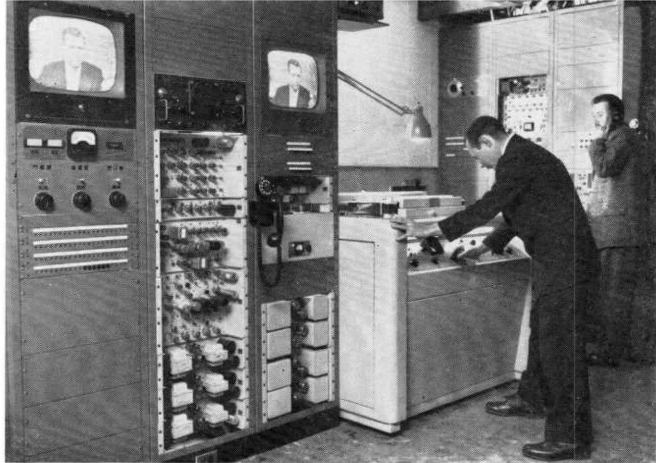
Foto 34. Het prototype van de Ampex videorecorder in 1956 in gebruik bij het Columbia televisiestation in Amerika. Links en rechts de rekken waarin zich het voor het opnemen en uitzenden nodige elektronische gedeelte bevindt. (werkfoto Ampex)
