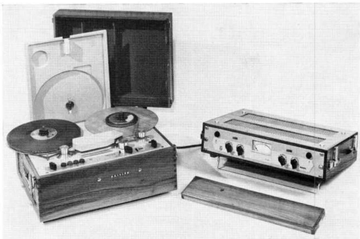
Foto 30. Professionele recorder in transportabele uitvoering, ingericht voor twee bandsnelheden. De linker koffer bevat uitsluitend het mechanische gedeelte; het elektronische gedeelte is ondergebracht in de rechter koffer.
