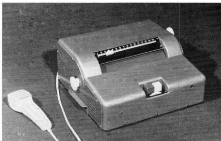
Foto 27. Dicteermachine waarbij als opneemmedium gebruik wordt gemaakt van een vel magnetisch materiaal dat op een rol kan worden gewikkeld. Opneemtijd 15 minuten per vel.
