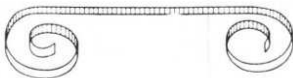
Fig. 155. Magneetband voorzien van een stroboscoopverdeling op de achterzijde.
