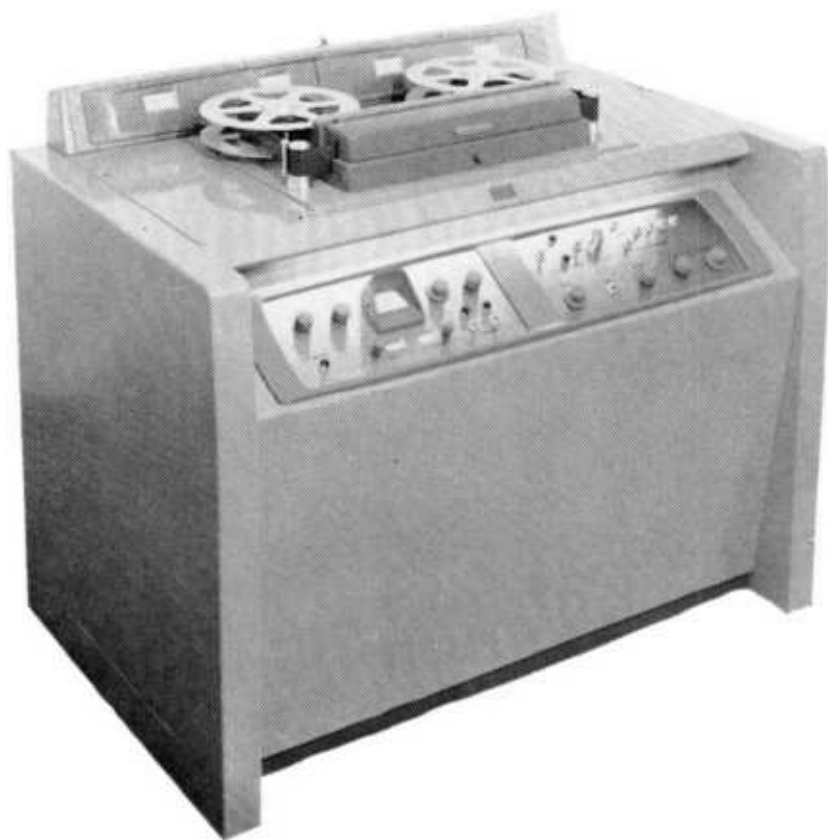
Foto 33. De Ampex magnetische beeldrecorder VR-1000. Op een 5 cm brede magneetband worden zowel het beeld als het geluid vastgelegd. (werkfoto Ampex)
