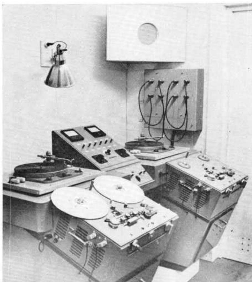
Foto 37. Installatie voor het verzorgen van geluidseffecten bij toneelstukken. De installatie bestaat uit twee professionele recorders en twee professionele draaitafels.
