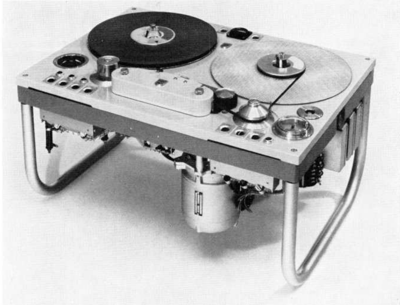
Foto 12. Mechanisch gedeelte van een professionele recorder met een bandsnelheid van 76 en 38 cm/s.
