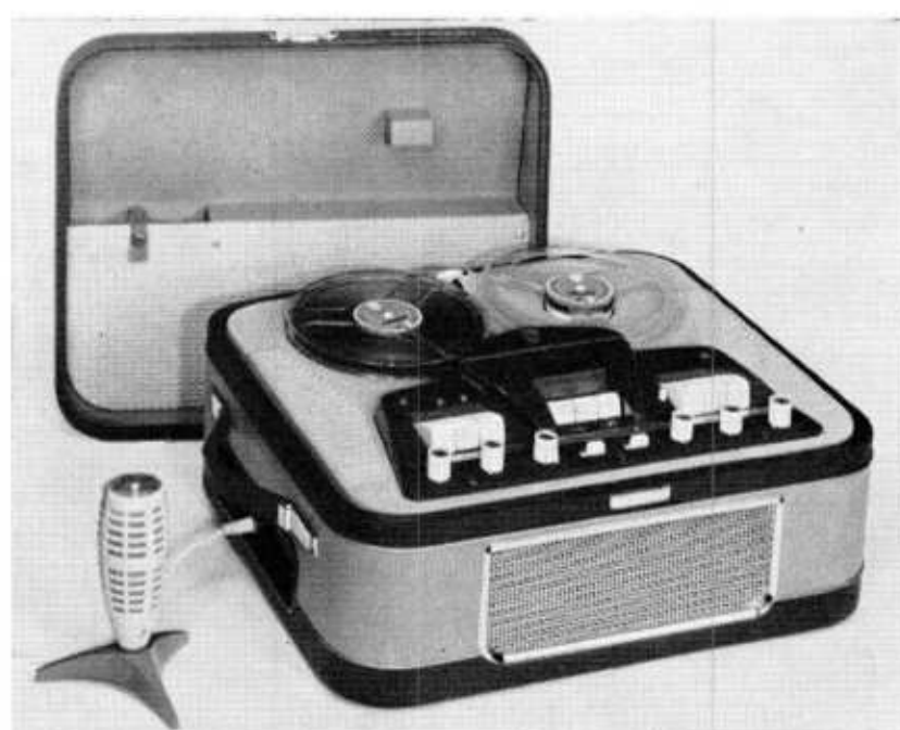
Foto 15. Recorder uit de hoogste prijsklasse met 3 bandsnelheden, geschikt voor het opnemen en weergeven van stereofonisch geluid en van monauraal geluid. Druk- knopbediening, 18 cm spoe- len, 4 sporen techniek en twee eindversterkers.
